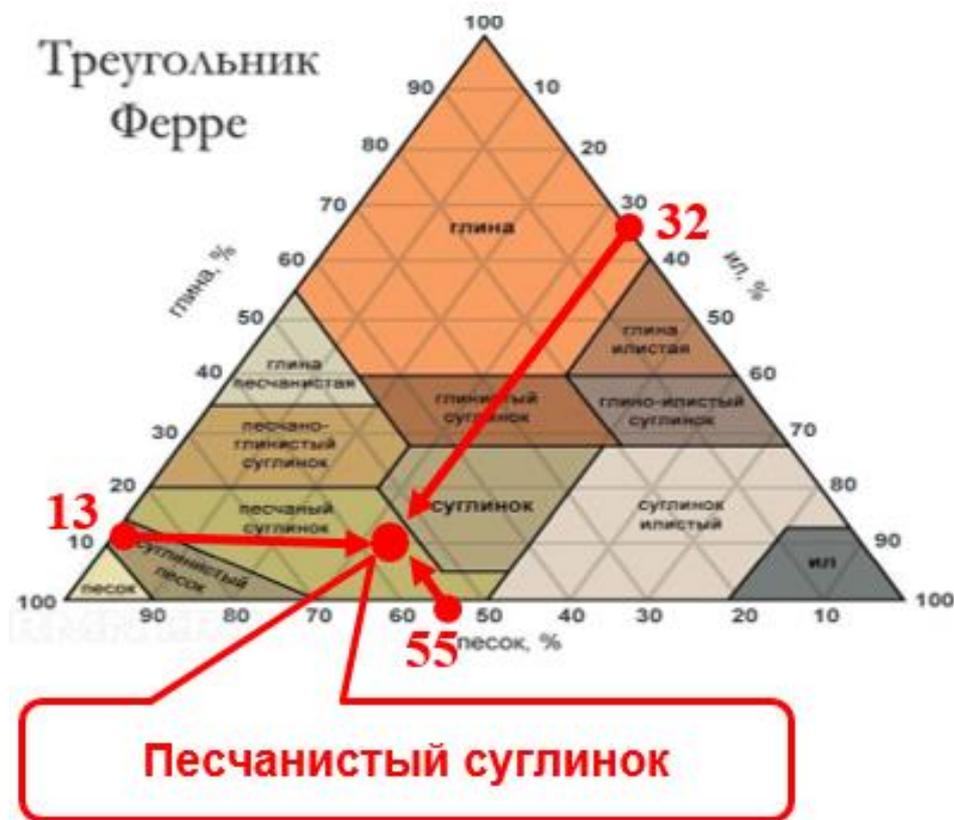
Рисунок 3 – Классификация грунта с помощью треугольника Ферре
